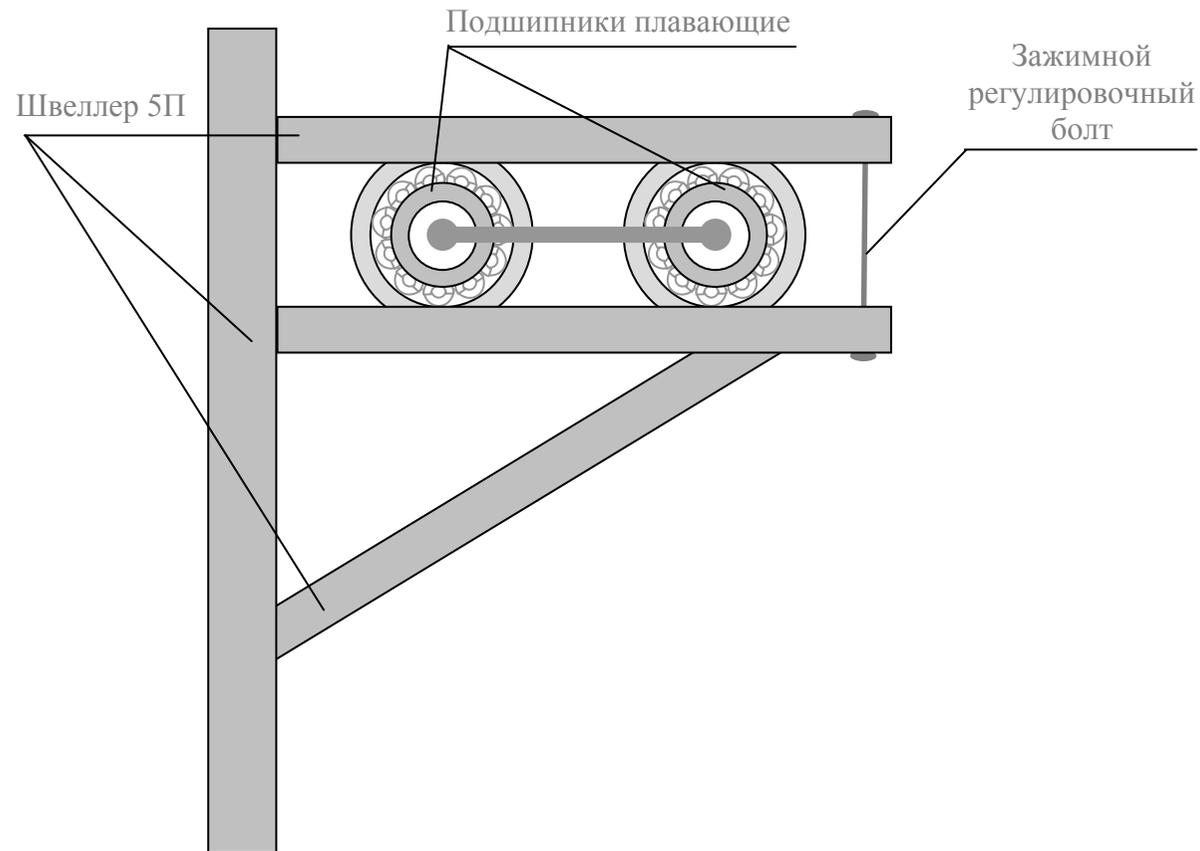
**При высоких (от 5м) рулонных ворот применяется система откатных, подвижных консолей. Механизм подъема - вал установлен на консолях, который представляет «плавающий» механизм из 2-х пар подшипников на каждую стойку, которая откатывает вал от проема по мере увеличения диаметра рулона при подъеме ворот. Этот вариант так же используется при интенсивно эксплуатируемых рулонных воротах, установленных на предприятиях, складах и т.д.**
