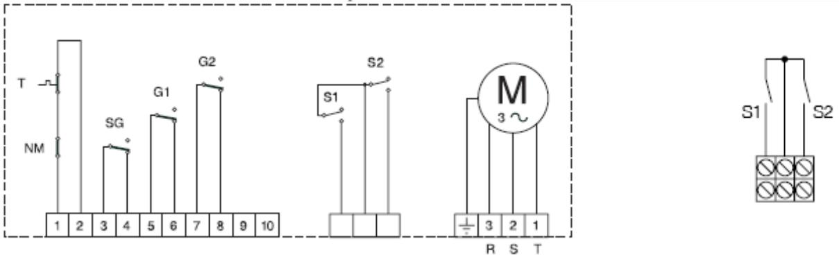
**Конечные выключатели привода, термореле, контакты безопасности на 10-ти клеммной колодке привода SC версии AB:**
