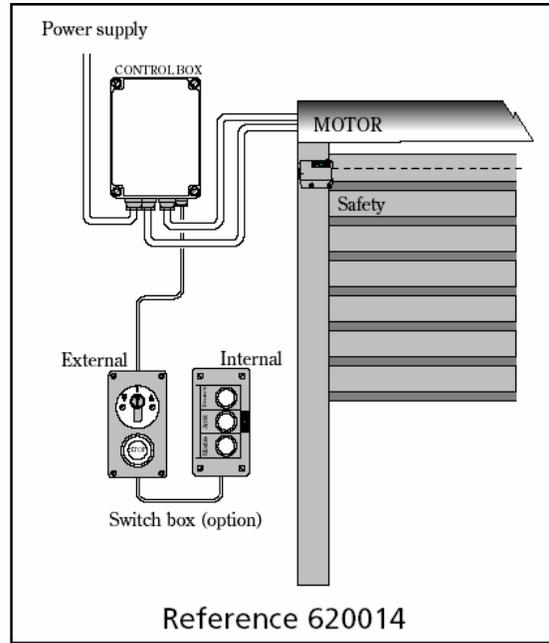
**Внимание:** Подключение производится согласно нормам CEI 364 и DIN VDE 0100, ПУЭ. Желто-зеленый кабель защитного заземления подсоединяется на контакты PE, которые не могут быть использованы для других целей.
