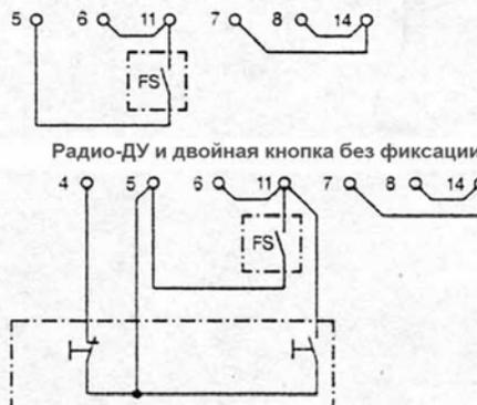
8-14 установите перемычку для подключения радиоуправления (должны быть установлены перемычки для фиксации ВВЕРХ и ВНИЗ)
